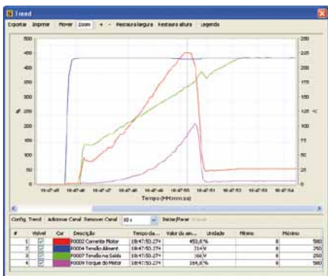
Função Trend que permite a análise dos dados de partida do motor (ex.: corrente, tensão, torque de partida, etc).
